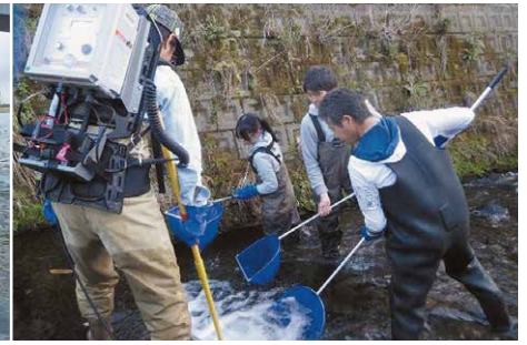
図3-3 魚を捕まえる手法③：電気ショッカー。水中に微量な電気を流して魚をしびれさせ、浮いてきた魚を網ですくって捕まえる方法。流れの速い川や濁った池で捕り逃さないように捕まえるのは難しい。また、塩水や深い場所ではこの方法は使えない
